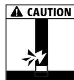
Bauteilversagen durch gestörte Druckzone! Keinerlei Gegenstände wie Abstandhalter, Leitungen, Rohre, etc. über das Drucklager führen. Beton gut verdichten.
