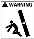
**Kippgefahr durch gelenkigen Anschluss am Wandfuss!**
