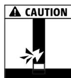
**CAUTION** Bauteilversagen durch gestörte Druckzone! Keinerlei Gegenstände wie Abstandhalter, Leitungen, Rohre, etc. über das Drucklager führen. Beton gut verdichten.
