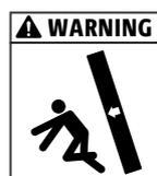
**WARNING** Kippgefahr durch gelenkigen Anschluss am Wandfuss! Wände auf Scconnex® Typ W in allen Bauzuständen gegen Kippen sichern!
