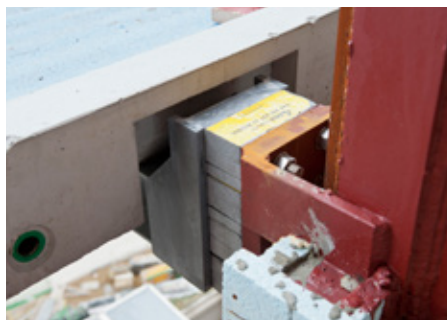
Abb. 1: Isokorb® mit Kopfplatte und Laschen,
