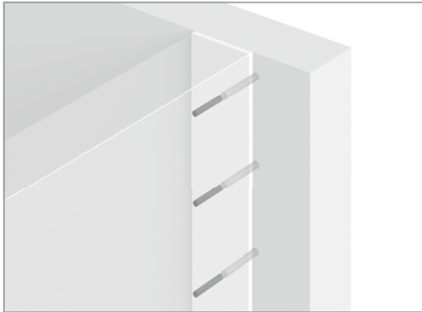
Abb. 11: Schöck Stacon®: Anschluss Wand–Wand (Stirn–Flanke)
