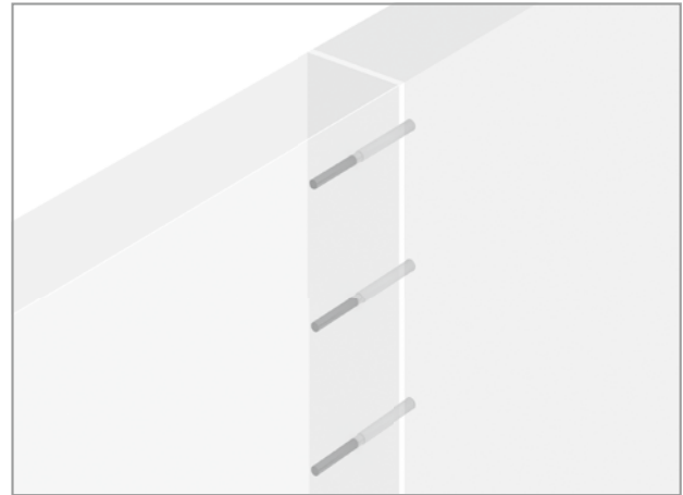
Abb. 12: Schöck Stacon®: Anschluss Wand–Wand (Stirn–Stirn)
