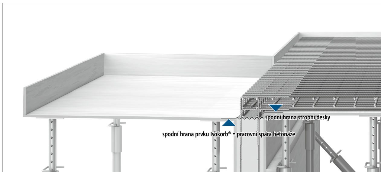
Obr. 32: Schöck Isokorb® T typ KL: Příprava bednění a výztuže před betonáží; úroveň pracovní spáry - stěna = úroveň bednění - spodní hrana balkónové desky!
