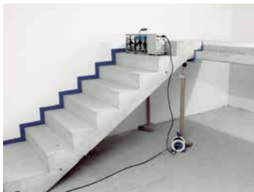
Realna preizkusna postavitvev po DIN 7396
