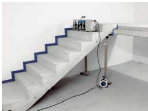
Zkušební konstrukce (odpovídající realitě) dle DIN 7396
