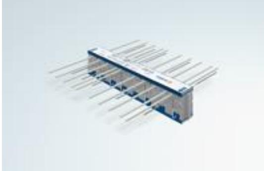
*Die Zugstäbe des tragenden Wärmedämmelements Schöck Isokorb CXT bestehen aus Combar, einem Glasfaserverbundwerkstoff, der sich durch geringste Wärmeleitfähigkeit auszeichnet. Foto: Schöck Bauteile GmbH*
