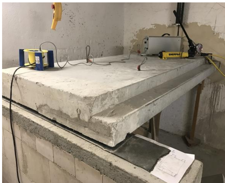
Abbildung 5: Prüfaufbau des mit der Schöck Tronsole® Typ Z-VH+VH entkoppelten Referenztreppenpodestes
