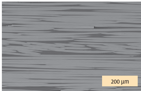
Coupe longitudinale d'une barre Schöck Combar®
