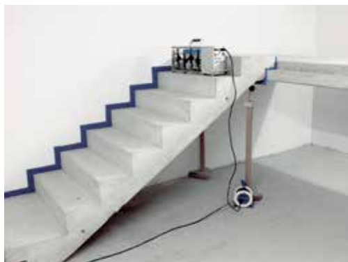
Realitätsnaher Prüfaufbau nach DIN 7396
