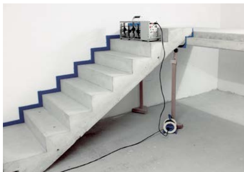
Zbliżona do rzeczywistych warunków konfiguracja podczas badań zgodnie z DIN 7396
