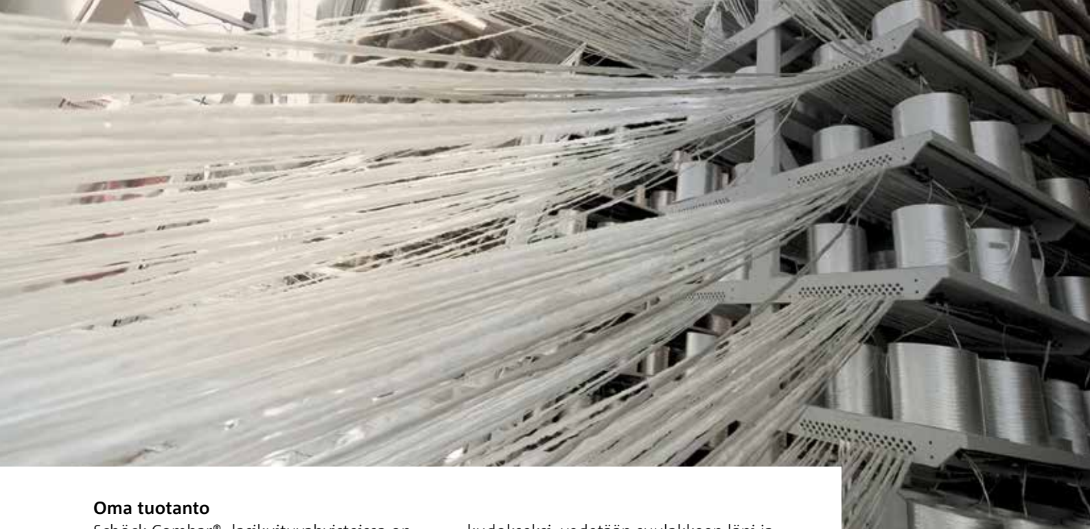
Roving-puolat ja kuitujen ohjaus suulakevedossa (©Fiberline Composites A/S)
