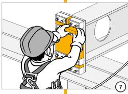
Tixer les pièces d'isolation intercalaires, le cas échéant, sur la platine frontale de la poutre d'acier entre les corps isolants des rupteurs Schöck Isokorb® Type S22.
