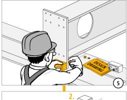
⑤ Fixer les rupteurs Schöck Isokorb® Type S22 sur la platine frontale de la poutre d'acier de l'ossature intérieure selon les dessins d'exécution.
