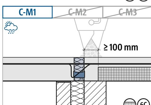
⑥A – ⑥C Remplir obligatoirement le joint de compression par du béton coulé sur place ! Largeur du joint ≥ 100 mm.
