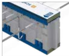
Isolant Néopor® en polystyrène expansé graphite de haute densité ( $\lambda = 0,031 \text{ W}/(\text{mK})$ ).
