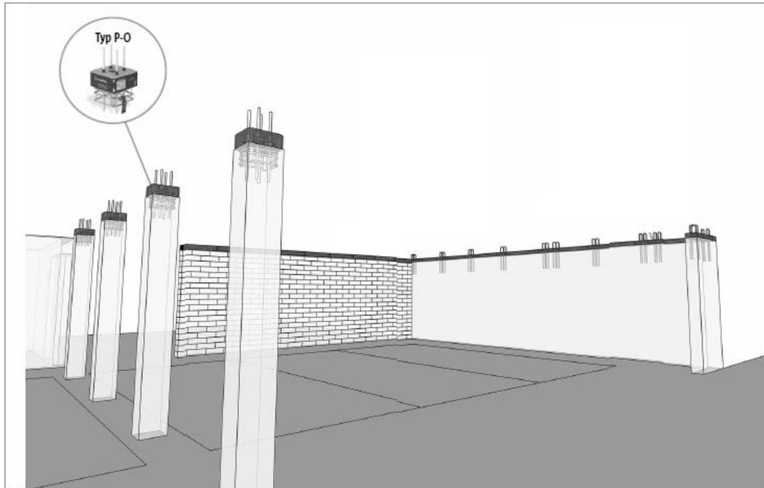
Sconnex® Typ P-O im Einsatz bei Unterdeckendämmung
