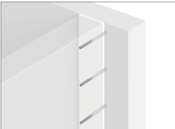
Fig. 9: perno Schöck: raccordo parete-parete (fronte-lato)
