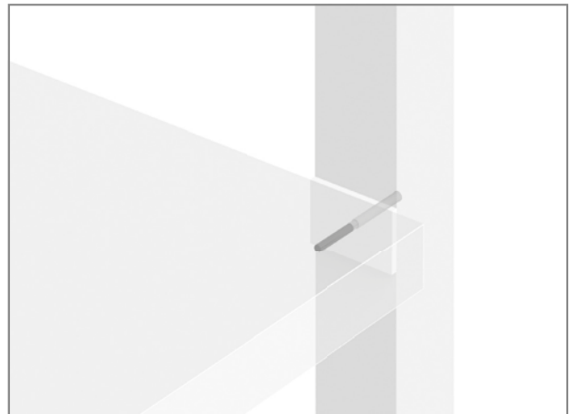
Fig. 8: perno Schöck: raccordo soletta-pilastro
